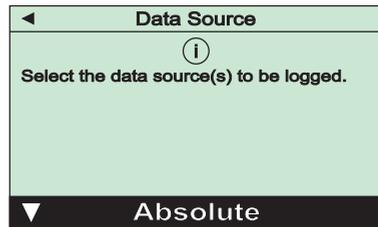
Unter diesem Menüpunkt kann die Datenquelle für den Datenlogger gewählt werden, d.h. ob Absolutdruck, Relativdruck oder beide aufgezeichnet werden sollen. Die Auswahl muss abschließend noch mit der "OK"-Taste bestätigt werden.
