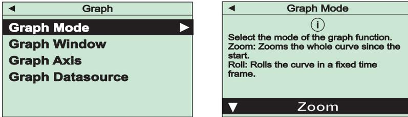
Unter diesem Menüpunkt wird ausgewählt, ob im Druck-Zeit-Diagramm alle Messwerte ab Beginn des Plots dargestellt werden ("Zoom"), oder Messwerte rollierend in einem separat festzulegenden Zeitfenster bis zum aktuellen Messwert ("Roll"). Die Auswahl muss mit der "OK"-Taste bestätigt werden.
