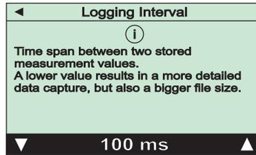
Mit dem hier einzustellenden Zeitintervall werden nach dem Start des Datenloggers fortlaufend neue Messwerte gespeichert. Der gewählte Wert muss abschließend noch mit der "OK"-Taste bestätigt werden.
