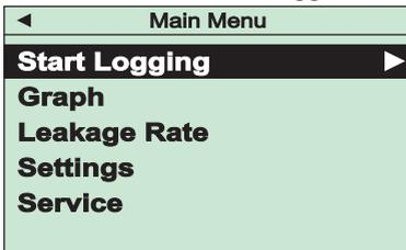
Es erscheint eine Information mit dem automatisch vergebenen Namen der Messwert-Datei sowie die in der Konfiguration eingestellte Speicherrate. Nach der Bestätigung mit der "OK"-Taste beginnt unmittelbar die Datenaufzeichnung. In der Messwertanzeige wird als Betriebsmode "Logging" angezeigt.
