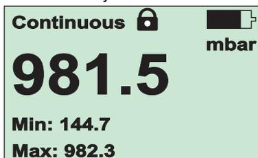
Die Sperre kann wieder aufgehoben werden, indem die Taste "Pfeil oben" innerhalb von 5 s zweimal gedrückt wird.
