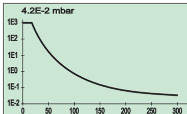
Je nach Diagramm-Einstellungen wird nun der gemessene Druck über der Zeit geplottet. Über dem Diagramm ist der aktuelle Messwert numerisch eingeblendet.
