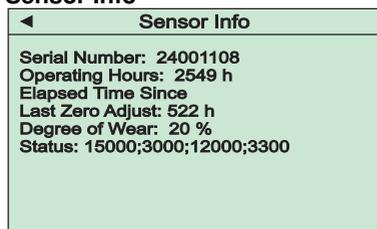
Unter diesem Menüpunkt werden Informationen zum Sensor des Geräts angezeigt, u.a. auch Parameter, die zur Beurteilung des Verschleißgrades relevant sind.
