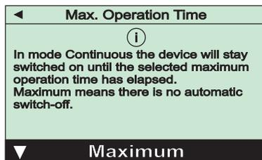
Mit dieser Funktion kann dafür gesorgt werden, dass das VD810 auch im Dauerbetrieb "Continuous" nach einer einstellbaren maximalen Betriebszeit automatisch abschaltet. Dies vermeidet ungewollte Entladung der Batterie. Ausgewählt werden können "Maximum" (keine Abschaltung) oder vorgegebene Laufzeiten zwischen 30 min und 5 h.
