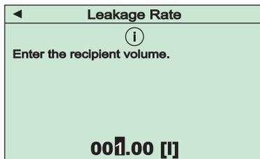
Im nächsten Schritt muss nun das Volumen der Vakuumkammer bzw. des verwendeten Vakuumsystems eingegeben werden. Nach Bestätigung des eingestellten Werts mit der "OK"-Taste beginnt die Druckanstiegsmessung mit fortlaufender Berechnung der Leckrate:
