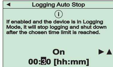
Diese Funktion beendet den Betrieb als Datenlogger automatisch nach einer einstellbaren Zeitspanne.
