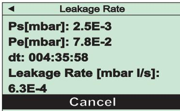
Angezeigt werden der Startdruck  $P_s$ , der aktuelle Enddruck  $P_e$ , die verstrichene Anstiegszeit  $dt$  sowie die berechnete Leckrate.
