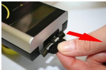
Die Buchsen für Steckernetzteil und USB liegen hinter einem Staubschutzdeckel.
